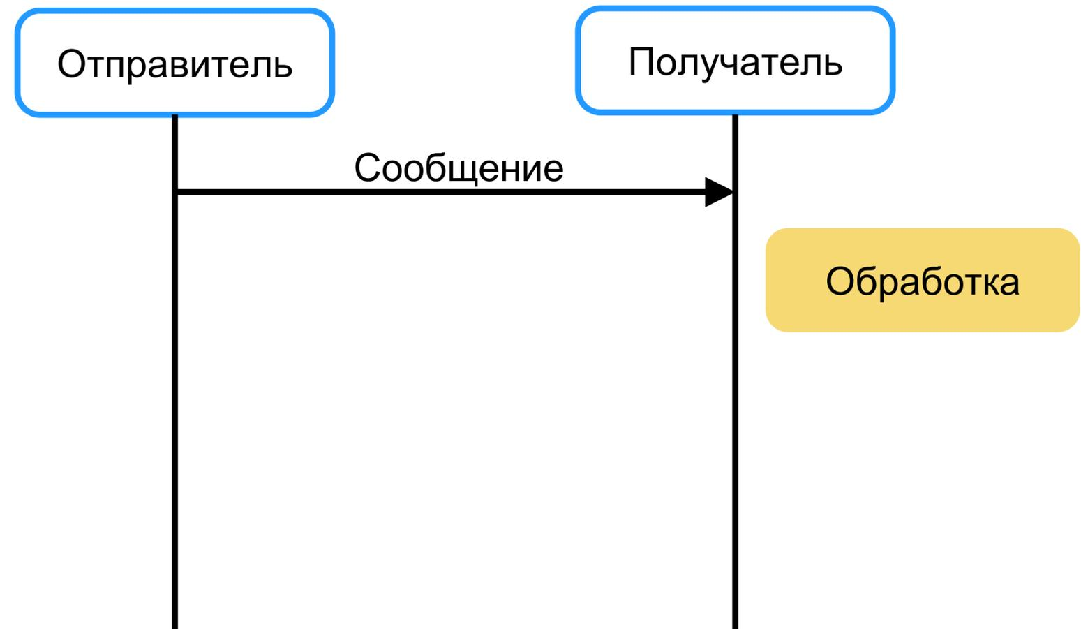
Пример: периодическая отправка состояния, отправка координат автомобиля в движении
