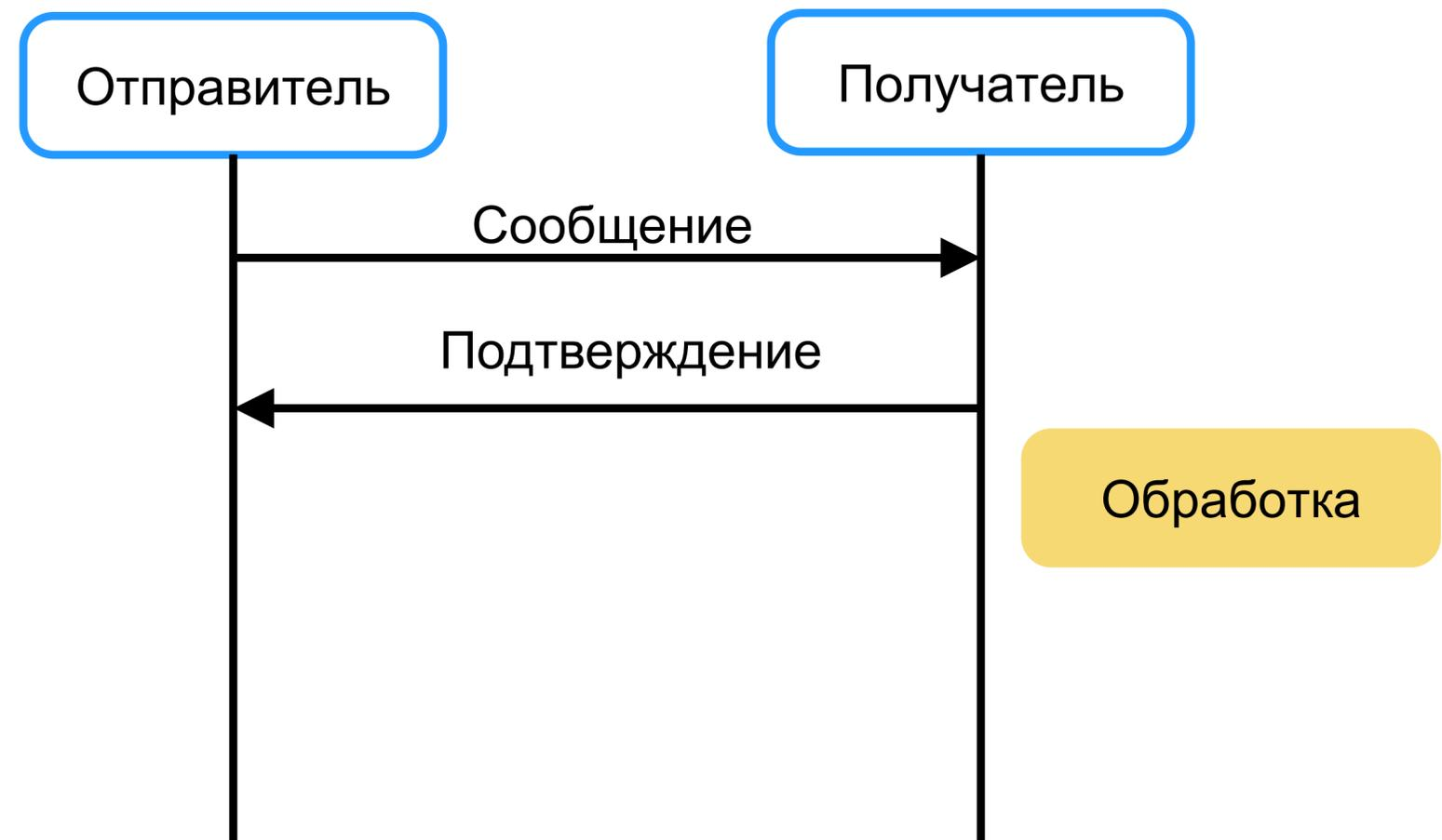
Пример: отправка координат автомобиля учитывает подтверждение для планирования следующей отправки
